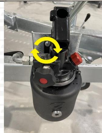
3. Insérer la poignée dans le trou et la déplacer de haut en bas jusqu'à ce que les pare-chocs reposent sur le sol.
